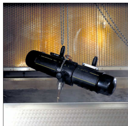
skúška hydrostatického tlaku
